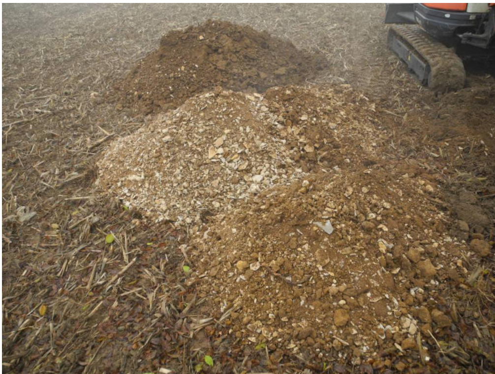
Abb. 2: In den Schürfen folgte unter den schluffigen Deckschichten (hinten) Kiese aus Kalksteinscherben mit wechselnden Feinkornanteilen (Mitte, vorne).
