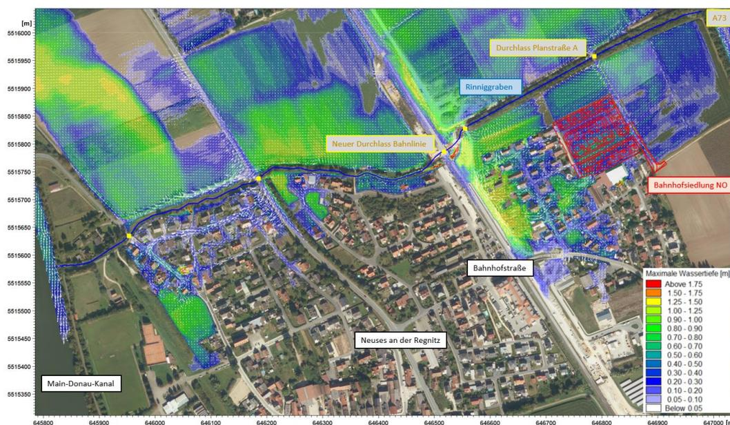
Abbildung 4-2: Berechnete maximale Wassertiefen im Istzustand im B-Plan und in den angrenzenden Bebauungen
