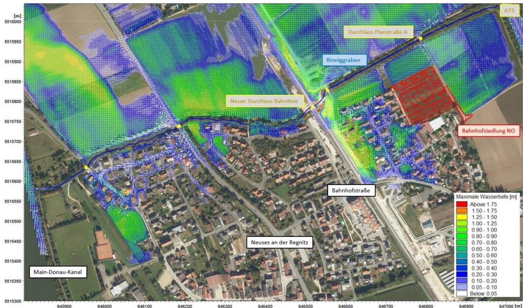
Abbildung 4-6: Berechnete maximale Wassertiefen im Planzustand im B-Plan und in den angrenzenden Bauungen
