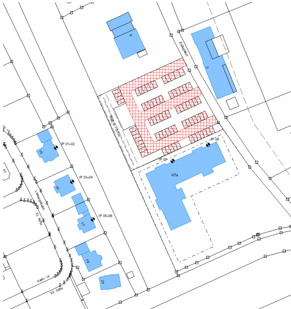
Übersichtslageplan im Schallschutzprogramm mit Schallquellen und Immissionspunkten sowie Lärm-schutzwall
