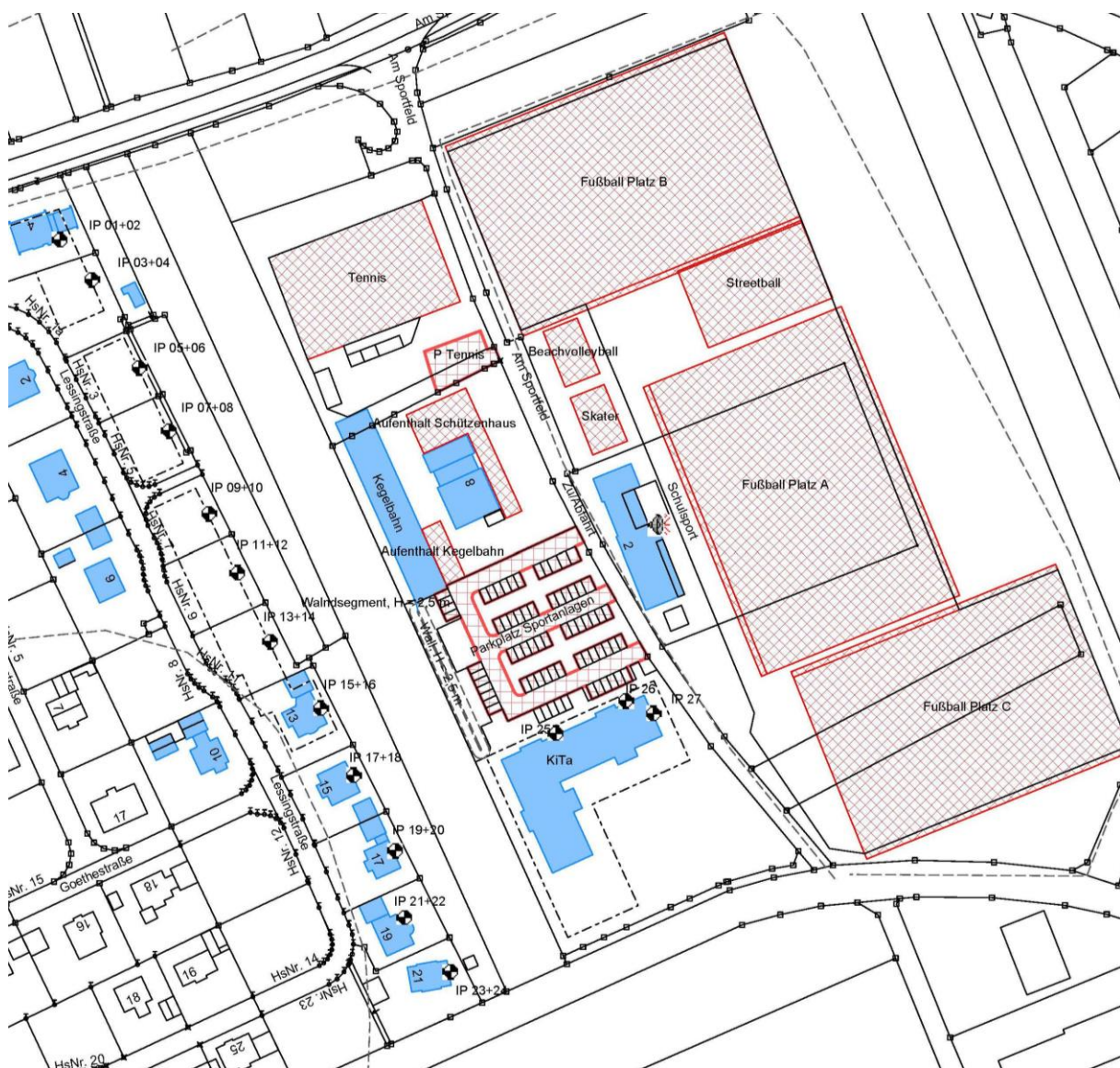
Lageplan im Schallschutzprogramm: Schallquellen und Immissionsorte
